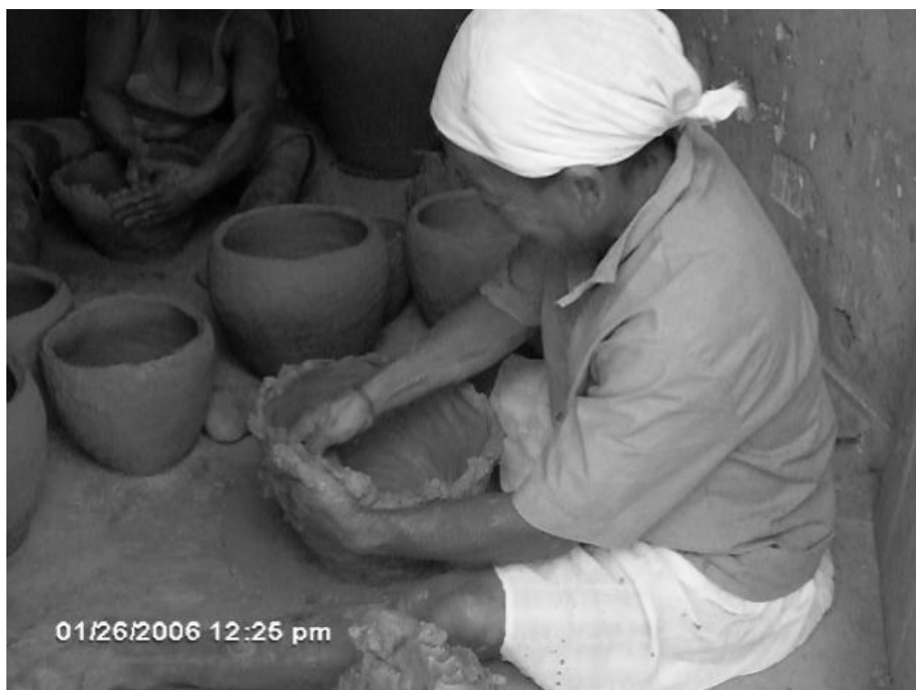
Imagem 1- Modelagem de peças cerâmicas
